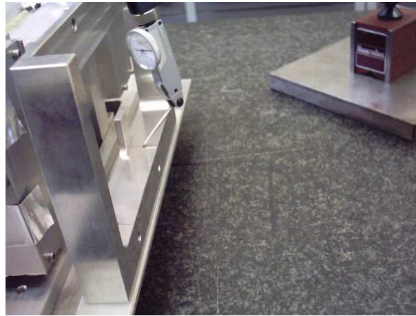
Abbildung 4.22: Vermessung einer Anlagefläche für ein Halbleiterdetektor-Gehäuse mit der Mikrometeruhr.
