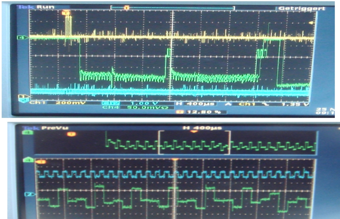
Abbildung 5.4: Erste Aufnahmen mit dem Oszilloskop, bei denen die Ausgabe der Treppenstufenfunktion zu sehen war.
