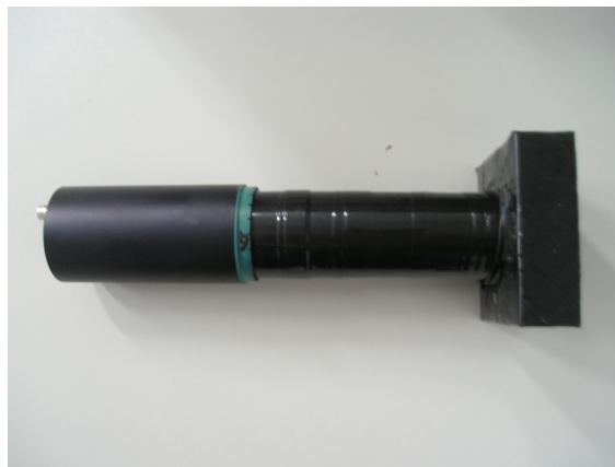
Abbildung 2.6: Plexiglasdetektor, wird zum Monitoren der eingestellten Pulsung verwendet. Daneben auch als Myontrigger bei Untersuchungen an ATLAS Driftrohren.
