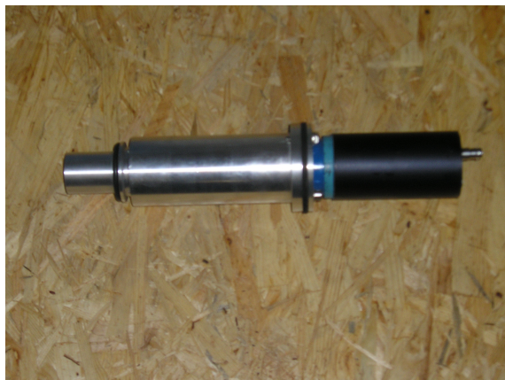
Abbildung 2.5: Rutherford-Szintillationdetektor, wird zum Monitoren der eingestellten Pulsung verwendet.
