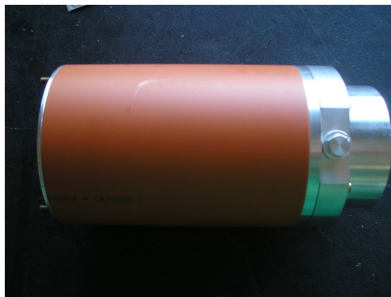
Abbildung 2.15: Hier erkennt man einen fertiggestellten AR-Detektor, die orangene PVC Umhüllung dient dazu den Detektor lichtdicht zu bekommen.
