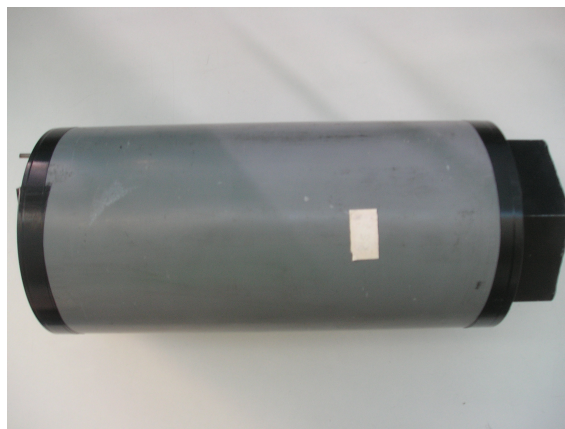
Abbildung 2.13: vollständiger Edelweiss Detektor, die graue PVC Abdeckung dient der lichtundurchlässigkeit des Detektors
