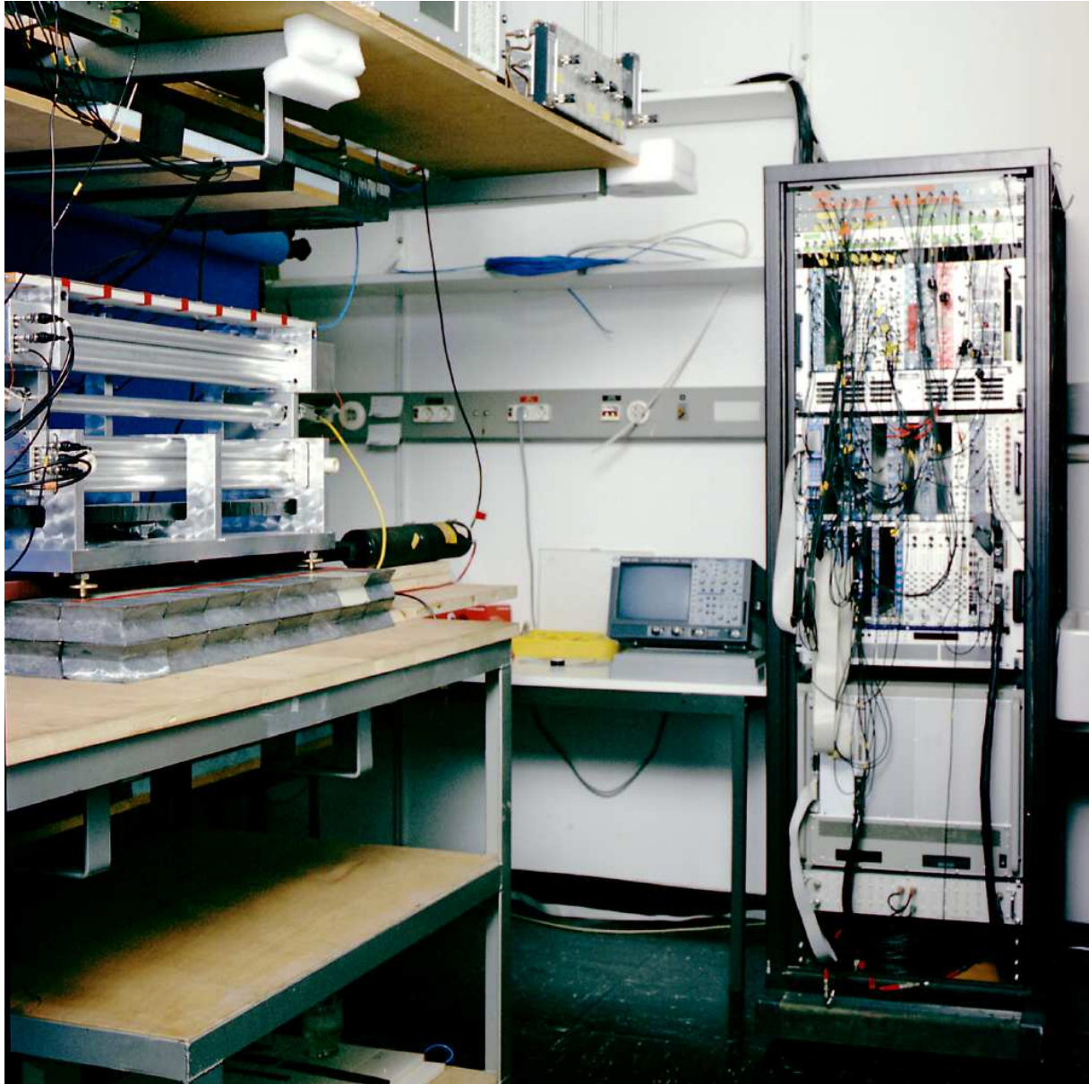
Abbildung 2.0: Gesamtansicht des Teststandes mit Auslese: Links ist die Prüfhaltung mit den Referenz-MDT's und den Triggerszintillatoren zu erkennen. Darüber, die Regelung der Gasversorgung für die Driftrohre und die Streamerkammern. Im Schrank, rechts auf dem Bild, befindet sich die Triggerelektronik und der Auslesecomputer.
