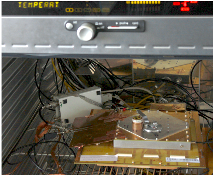
Abbildung 3.4: Messstand im Klimaschrank.
