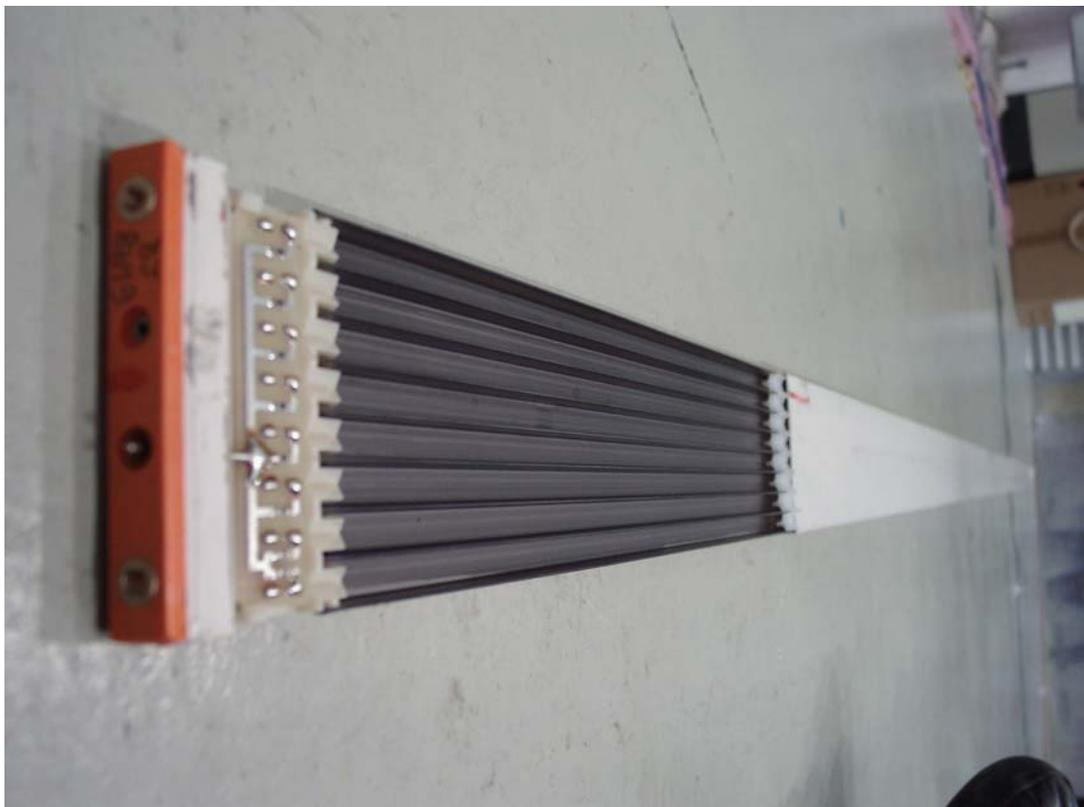
Bild 2: Die 8 Streamer – Rohre eines offenen Iarocci – Rohres
