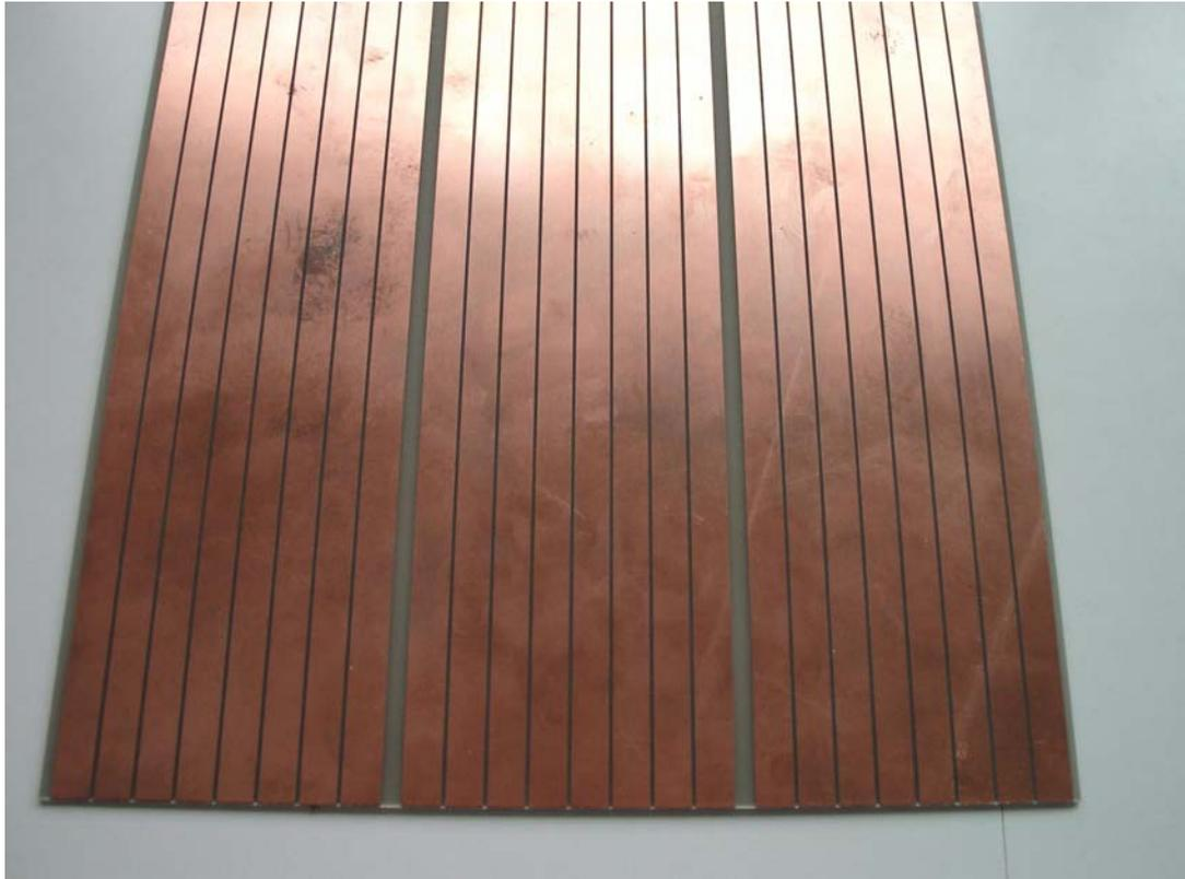
Bild 3: Vorderseite einer Influenzstreifenplatte
