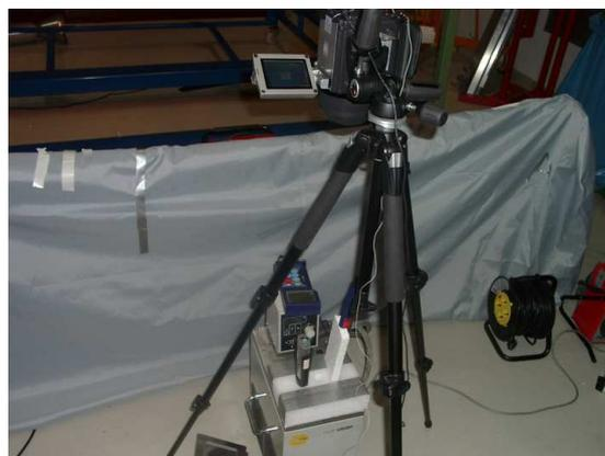
**Abbildung 6.2:** Aufbau mit Wasserbad und Styrodurabdeckung mit Öffnungen für die Thermometer, Kontaktthermometer (links), TH9100pro IR-Kamera (mittig oben) und Stabthermometer (rechts)
