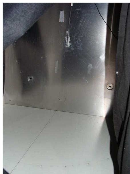
**Abbildung 6.22:** Aufbau des Winkelabhängigkeitsmessung mit Winkelplatte (Boden), Protective Cover (hinten) und Stabthermometer.
