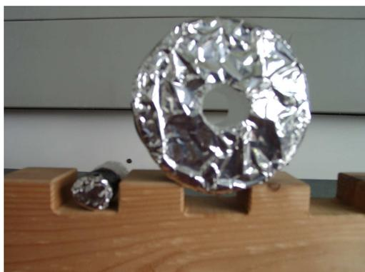
**Abbildung 6.29:** Bild des einseitig mit Alupapier verkleideten Pfropfens mit Loch.
