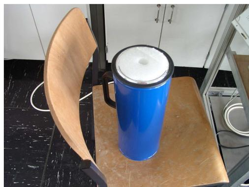
**Abbildung 6.30:** Fertiger Hohlraumstrahler aus Stickstoffdewar und Polyethylenpropfen.
