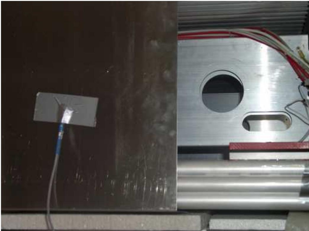
**Abbildung 7.5:** Aufnahme des Aufbaus. Linker Hand die über die Kammer angebrachte zusätzliche Aluplatte (mit Temperatursensor T5), rechts unten die drei Rohrlagen (gleich rechts außerhalb des Bildes befindet sich der Temperatursensor T18), darüber der Longbar (mit Temperatursensor T6, unsichtbar, etwa hinter T5 angebracht.) Rechter Hand stünde die IR-Kamera.
